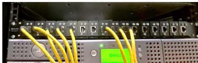
obr. 6 Multikanálová ochrana systémem zásuvných Plug&Play modulů do boxu DL-PL-RACK-1U
